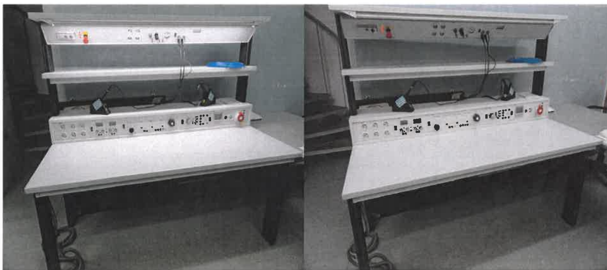
Slika 5. Novi instrumentalni stol sa energetske kanalom
