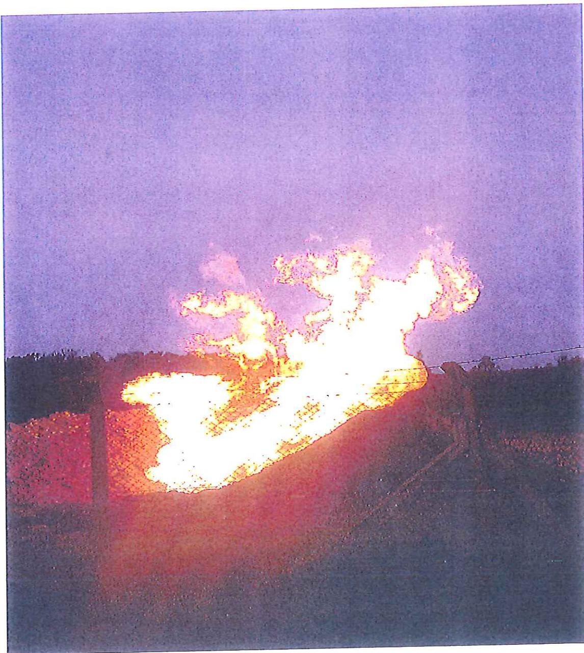
Slika 5. Spaljivanje plina na baklju (gušenje i čišćenje bušotine)
